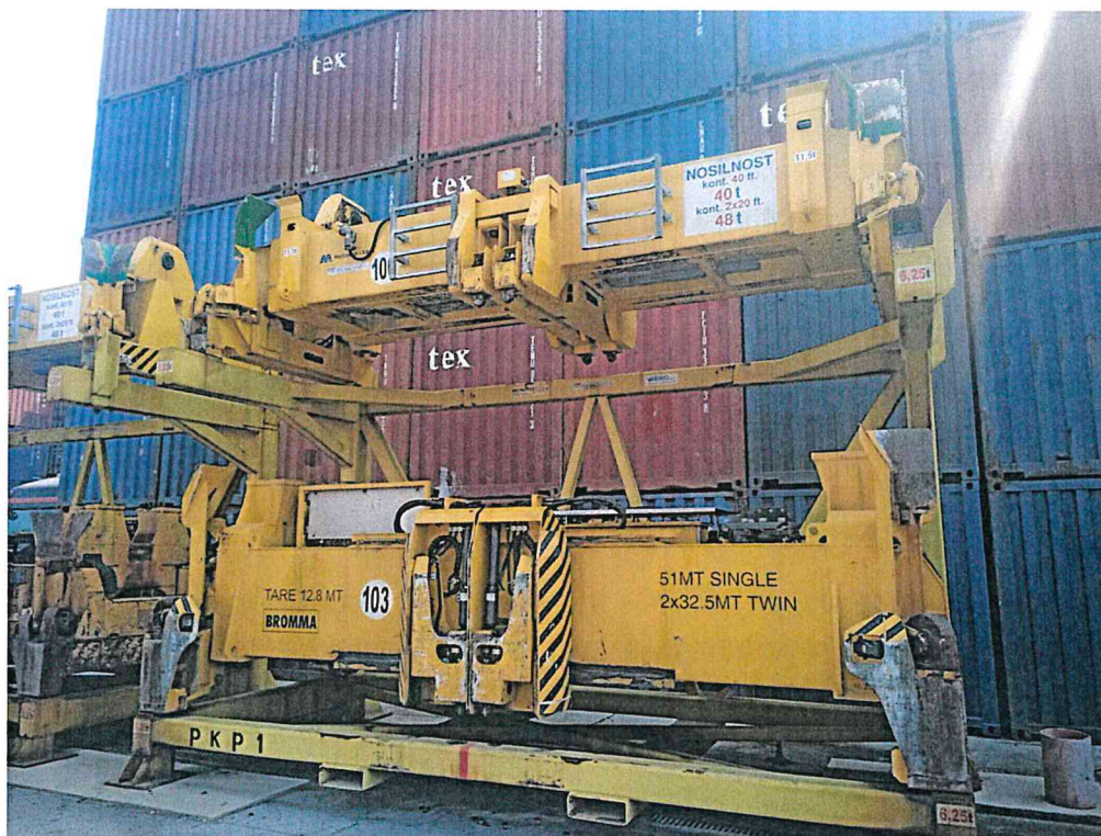
Slika 2: primer obstoječega podstavka z naloženima dvema spreaderjema
