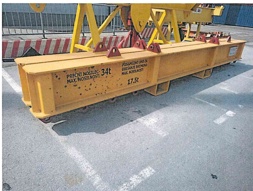
Slika 3.3 - Nosilec, prečni, nosilnosti 2 x 340 kN (rumena barva)
