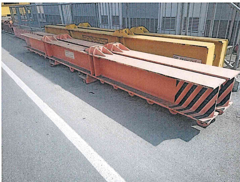
Slika 3.1 - Nosilec, prečni, nosilnosti 2 x 130 kN (oranžne barve)
