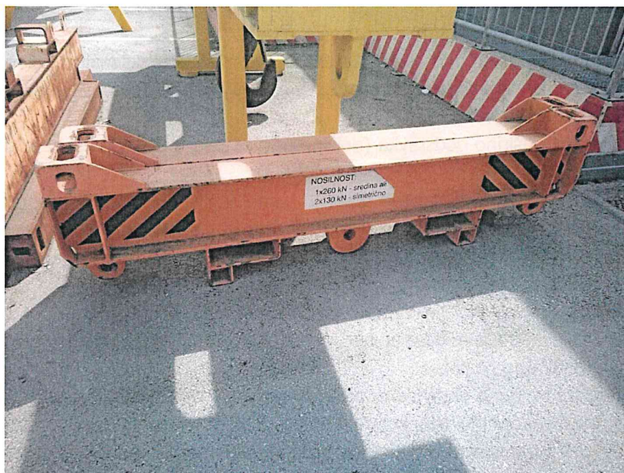
Slika 3.2 - Nosilec, prečni, nosilnosti 2 x 130 kN oz. 1 x 260 kN (oranžne barve)
