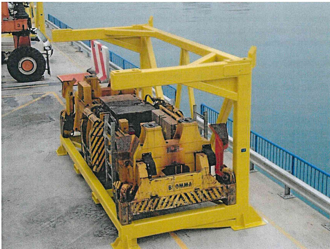
Slika 1: primer obstoječega podstavka za 2 kosa kontejnerskih prijemal-spreaderjev
